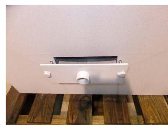
1次燃烧空気取り入れ口
